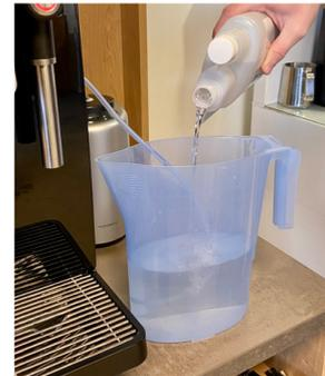
Verser 1L d'eau avec 50ml de produit détergent lait dans un récipient à côté de la machine. Brancher le tuyau à lait.
