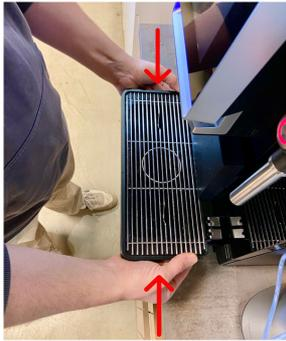
Retirer le bac à écoulement et à marc grâce aux deux petits clics situés de chaque côté du bac.
